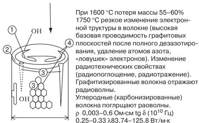
Рис. 2.41. Химизм процесса получения и структура при пиролизе ПАН [77, 96, 97]
